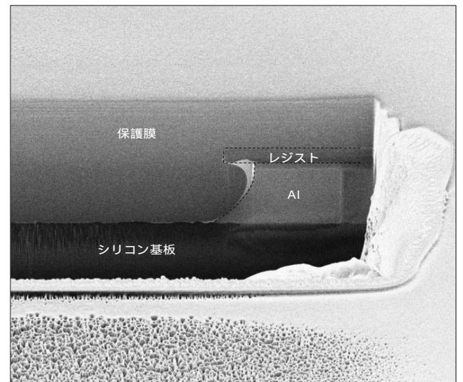
0.5よりも大きく、または - 0.5よりも小さくなると、Al膜はレジスト端部下面で  $x$  方向にエッチングが進み、エッチングされる Al 膜の幅は、レジスト幅よりも大きくなる。図中で、エッチングは  $x$  方向および  $y$  方向に進むが、 $y$  方向へのエッチング量の方が大きい。いずれの時間においても、Al 膜底面はほとんど平坦（へいたん）であり、その幅はレジスト幅  $W$  にほぼ等しい。Al 膜が溶け底面の位置が移動した量、すなわちエッチング量  $H_e$  が実験よりもやや少ない。しかし、平坦な底面と  $x$  方向へのエッチング量は、正確に求められている。
