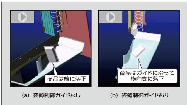
図10 ラック搬出後の商品落下挙動
