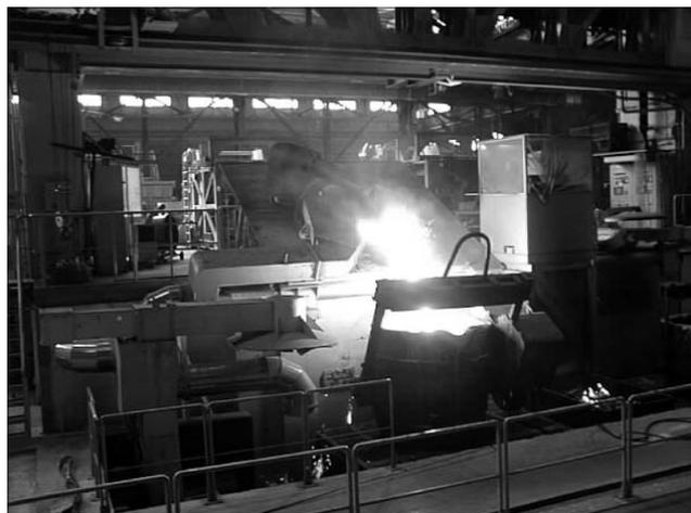
③ 高純度金属溶解精製装置
