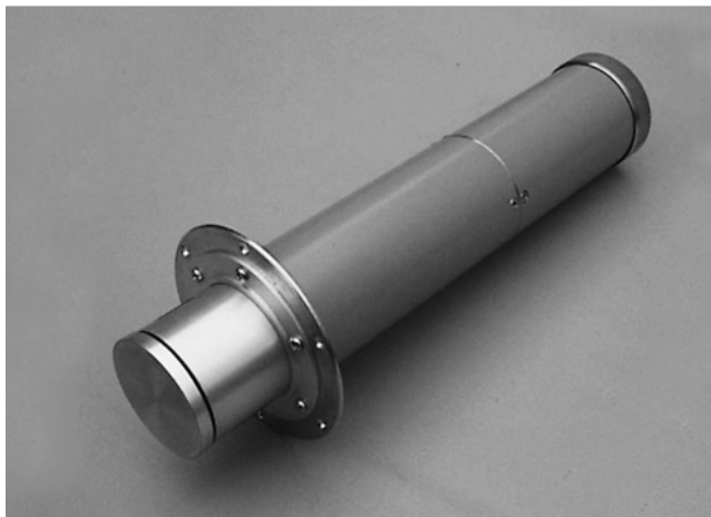
Fig.2 NaI (TI) scintillation detector
